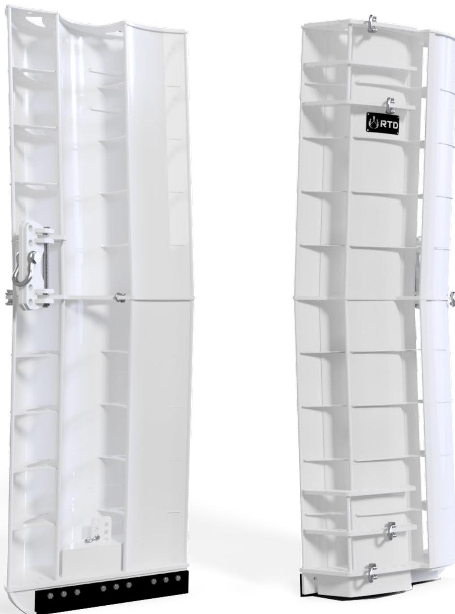
Пелагические **MESON 3.0** траловые доски подходят для промысла в разноглубинном режиме и на поверхности. Новая форма крыла позволяет увеличить распорную силу на **10%** в сравнении с более ранними крыловидными траловыми досками.
